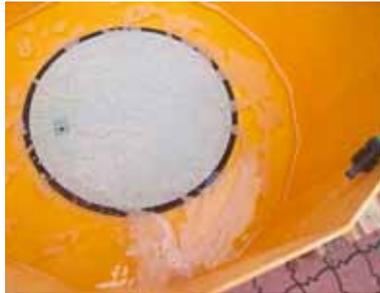
Für Testzwecke auf den Boden eines GPR Behälters eingesetzte FL60 Abdeckung mit Rahmen
